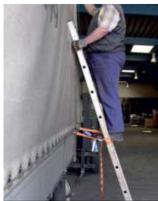
8 pav. Diržai kopėčioms- įtaisais pristatomų kopėčių užkabinimui prie tento
