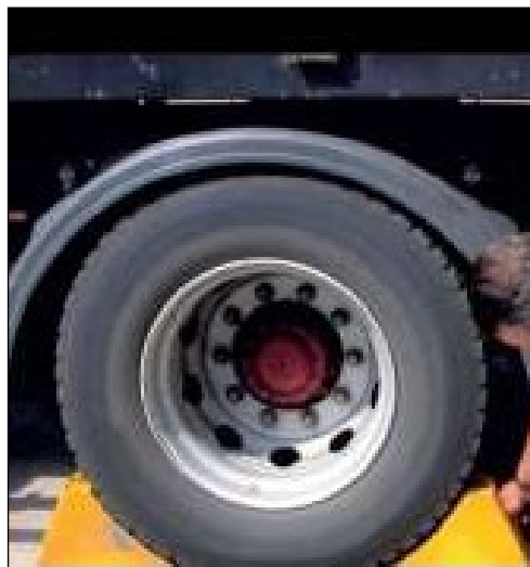
5 pav. Pakišamųjų pleištu padėjimas iš abiejų pusių, kai užvažiuojama krautuvu
